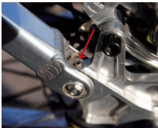
Duurzaam: alle draaipunten van de Turner Sultan zijn smerbaar.
